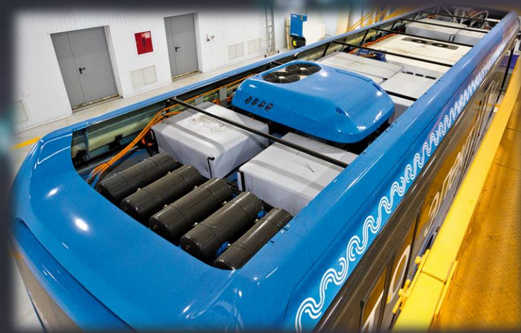
Рис.9 – Головная батарея \text{LiFePO}_4 .
